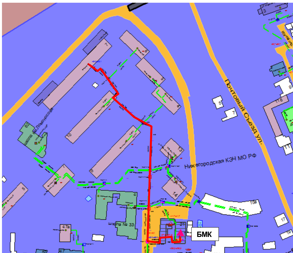
Рисунок 0.84 – Результат гидравлического расчета - расчетный путь теплоносителя от котельной Суетинская, 21 до ПТ-Федор,7
