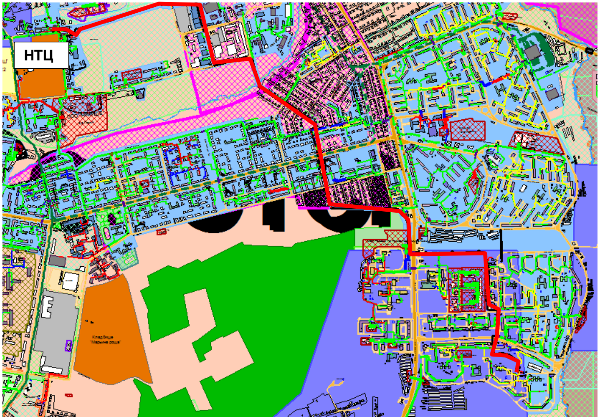
Рисунок 0.59 – Результат гидравлического расчета - расчетный путь теплоносителя от котельной НТЦ до ПТ-Малин,2 пристрой
