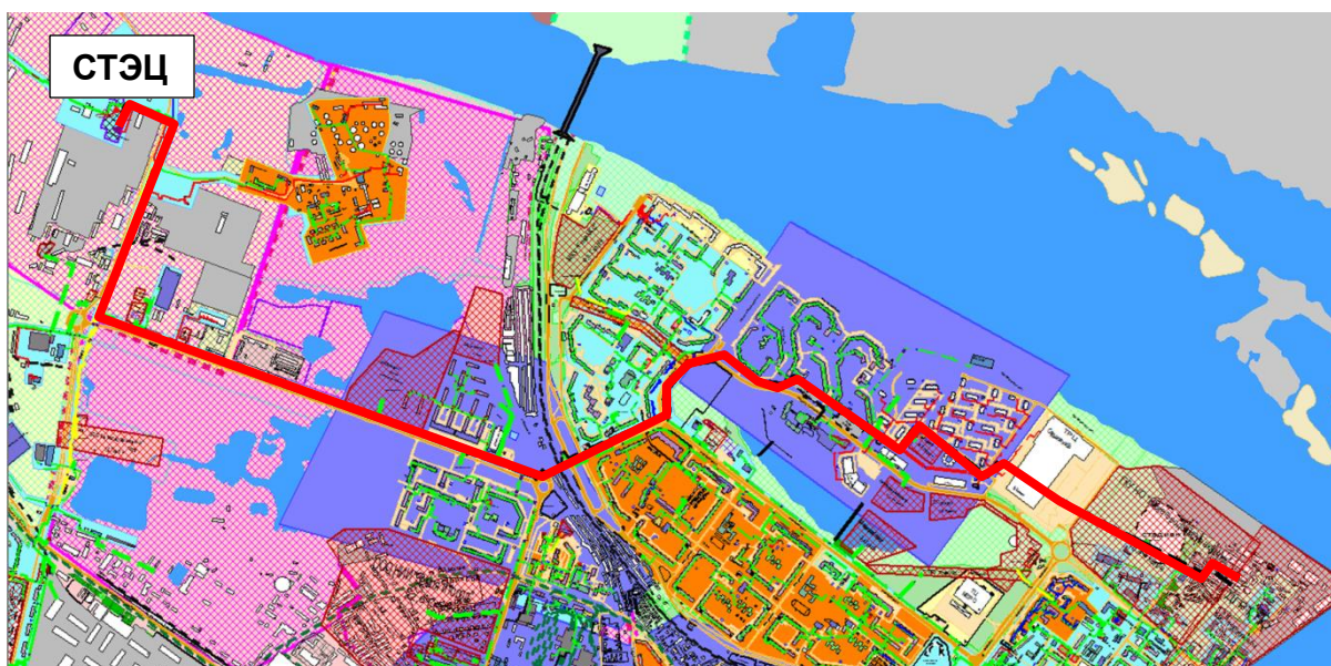
Рисунок 0.76 - Результат гидравлического расчета - расчетный путь теплоносителя от СТЭЦ до ПТ-ПП-2.64-2017
