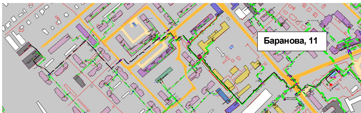
Рисунок 0.41 – Результат гидравлического расчета - расчетный путь теплоносителя от котельной пр. Союзный, д.43 до ПТ-Комин, 256 э2
